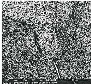
Cathode 1007 Grains disorientation (AHE)
